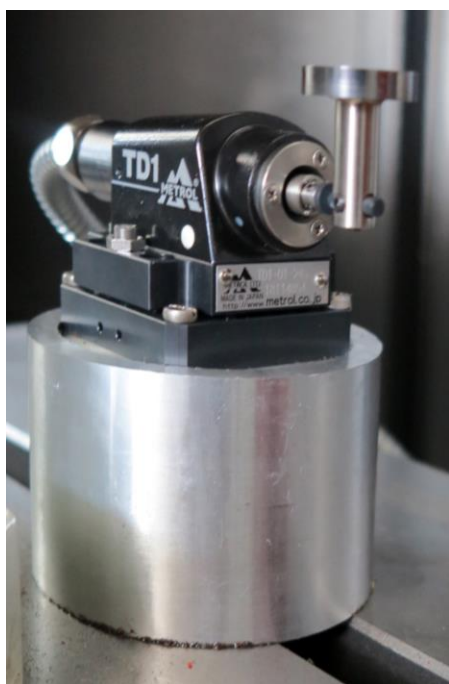
4. Система за мерене дължина и диаметър на инструмент METROL – Япония
