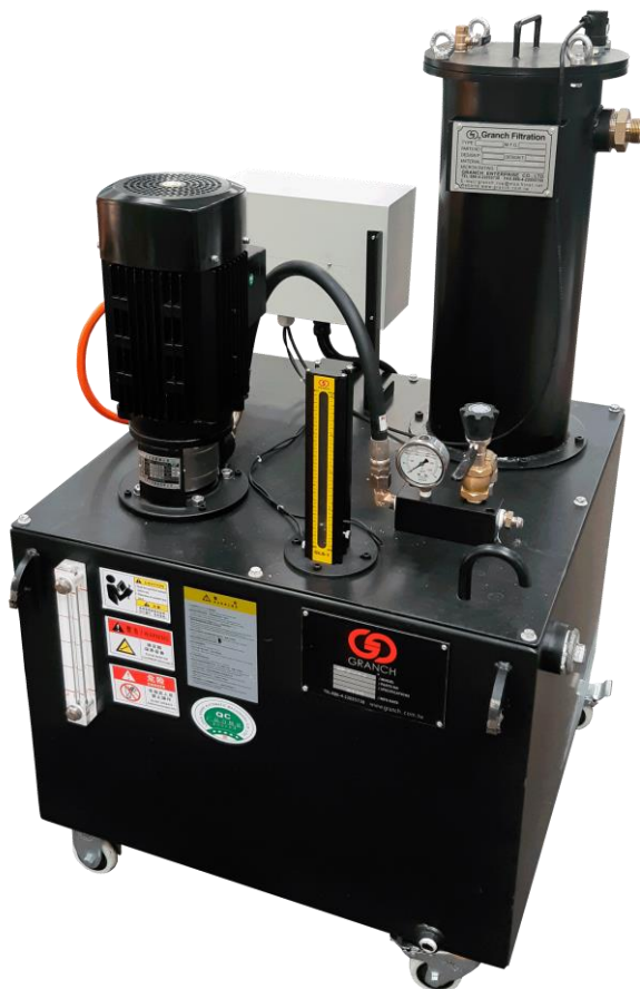
3. Система за охлаждане през шпиндела 40 bar
