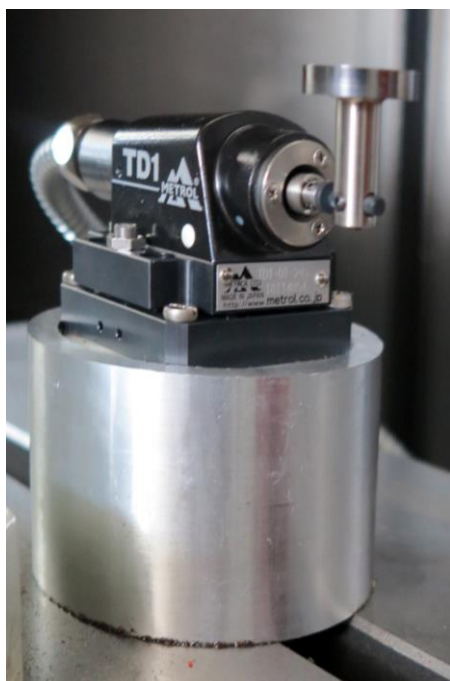
6. Система за мерене дължина и диаметър на инструмент METROL – Япония
